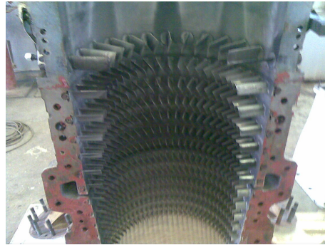
Figura 3.1: Hojas de estátor de una turbina de gas
