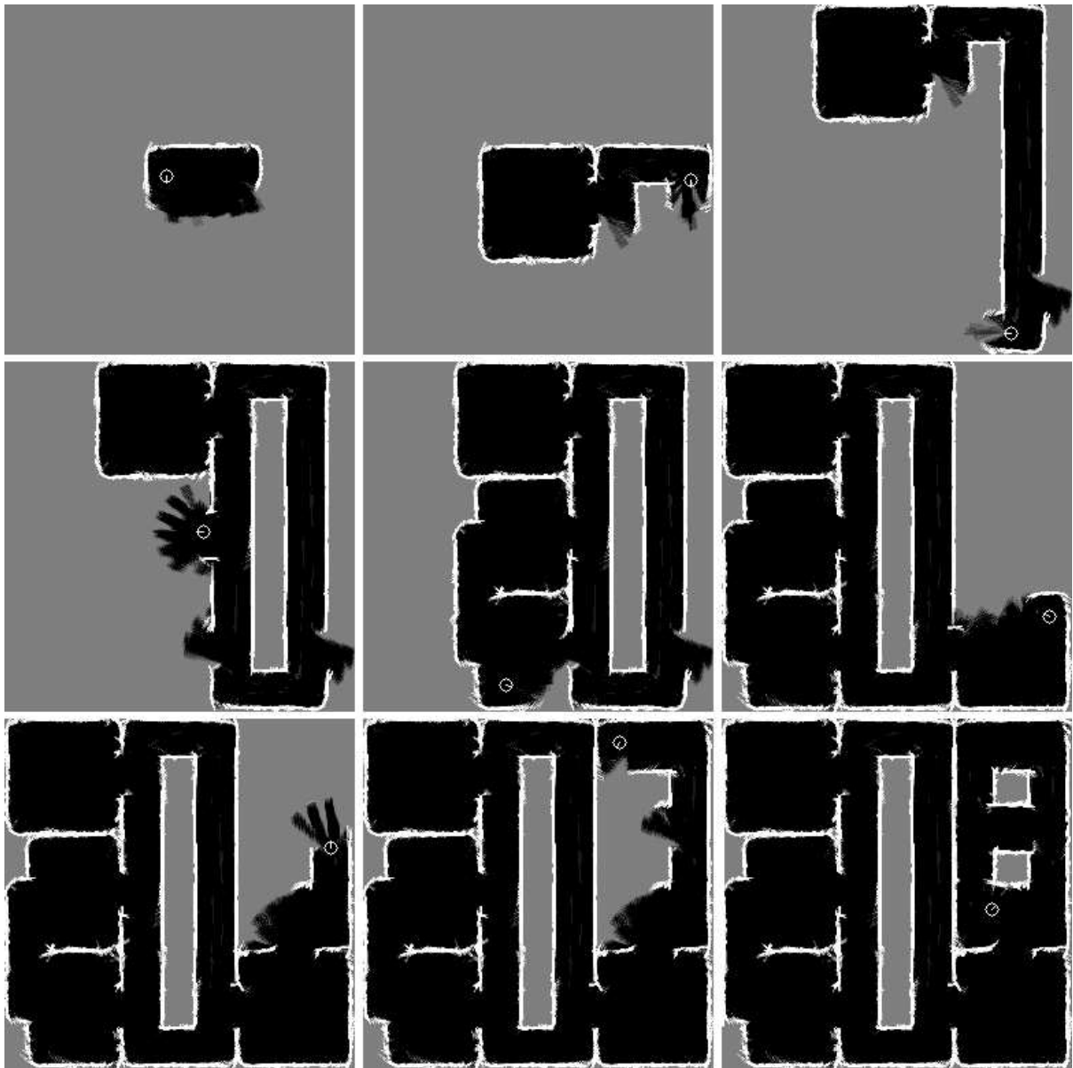
Figura 4.6: Generación del mapa métrico probabilístico mediante el método propuesto con tamaño de celda Size_Cell igual a 6 cm.
