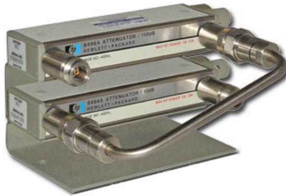
(a) Atenuadores calibrados ajustables Agilent 8494B y 8496B (fuente, [Agilent Tech.a, Agilent Tech.b])
