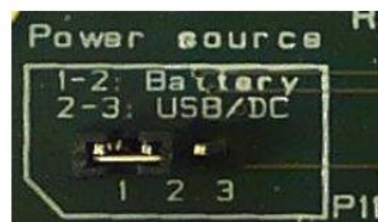
Figura 3.6. Jumper de selección de método de alimentación de la SmartRF05EB. Fuente [16].
